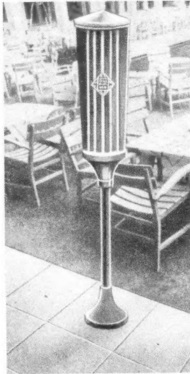
Bild 3. Die neuen Ton-säulen bestehen aus einer Anzahl senkrecht übereinander angeordneten Lautsprecher-systemen. Sie gestatten große Freiflächen mit verhältnismäßig geringer Leistung zu beschallen
