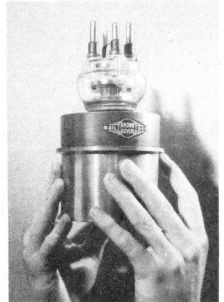
Bild 2. Luftgekühlte Sendetriode ATL 2—1 für 2 kW-Anodenverlustleistung
